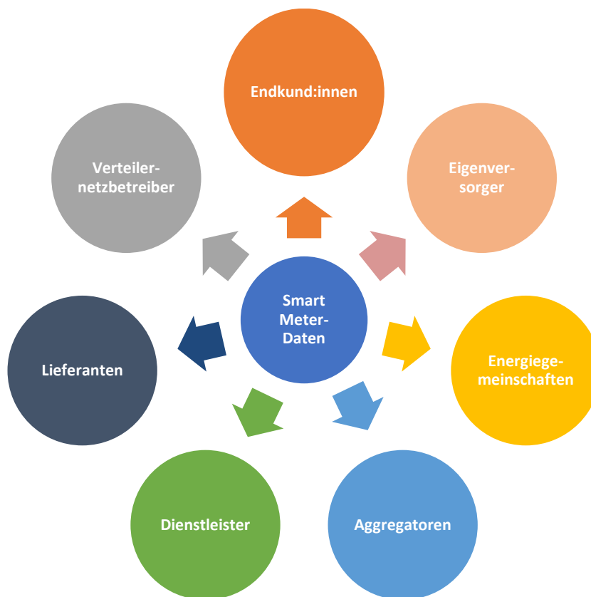
Abbildung 12: Austausch von Smart Meter-Daten zwischen verschiedenen Marktakteuren
