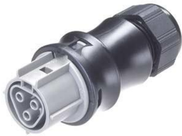
Abbildung 13: Rundsteckverbinder Photovoltaik für AC-Installationen vom Wechselrichter zum Netz 230 V / 32 A (wieland, 2016)
