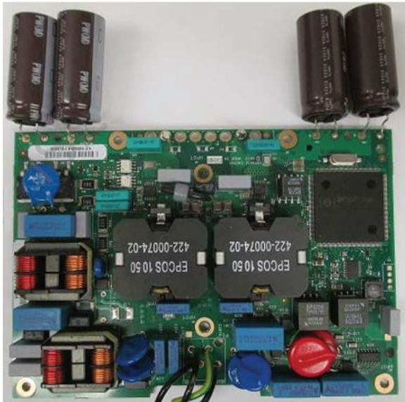
Abbildung 7: Wechselrichter mit HF-Transformator (die beiden grauen Klötzchen in der Platinenmitte), hier aufgeteilt in zwei parallele Zweige (enphase)
