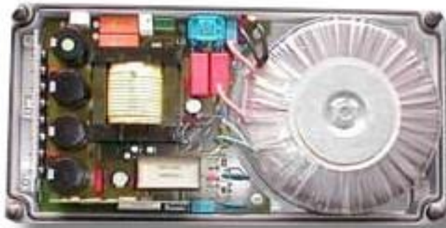
Abbildung 5: Blick in ein geöffnetes Gerät (Dorfmueller DMI 250); rechts der Ringkern-Niederspannungstransformator
